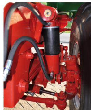
Zur Reifenschonung bei Leerfahrten und als Anfahr- bzw. Traktionshilfe kann eine Liftachse in das System integriert werden.
