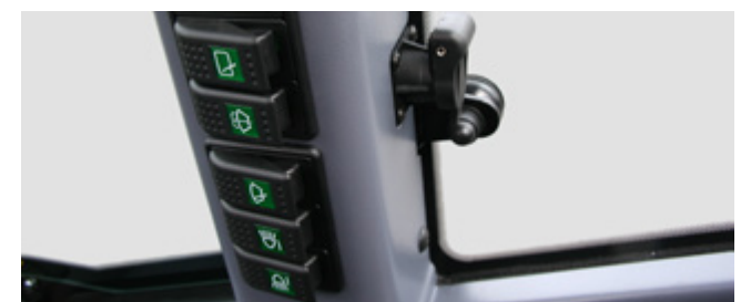
Zusammengefasste Schalterleiste, Steckdose mit Dauerstrom
