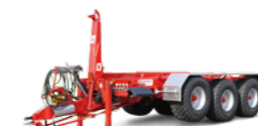
THL 30 (31 - 34 to Gesamtgewicht, 30 to Aufzugskraft)
