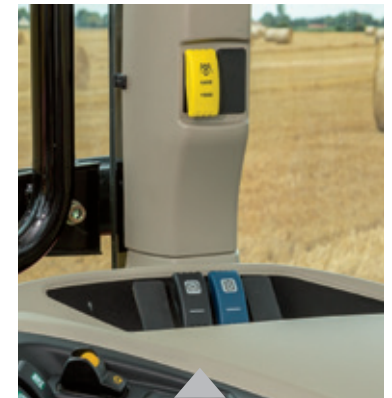
Neue Option für einen kombinierten „High flow“ Durchfluss von 100 l/min per Knopfdruck
